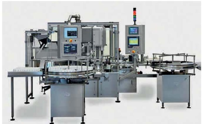
Auf dieser vielseitigen Anlage können die Prozesse Ausblasstation, Brutto/Tara-Verwiegung, Tablettenzählung mit/ohne Kamerasystem, automatische Verschlusszuführung, Vorverschraubung, Induktionsversiegelung, Nachverschraubung mit/ohne Anzugsdrehmoment-Messaufnehmer und Etikettierung mit/ohne Code-Verifizierung integriert werden. Selbstverständlich können hierzu alle nötigen Dokumentationen für die Pharma-Validierung mit angeboten werden.
