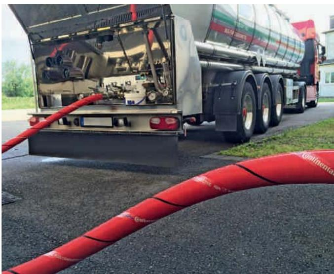
*Aufgrund ihrer elektrischen Ableitfähigkeit ist die Purpurschlange Plus Conductive optimal für den Einsatz in Ex-Zonen geeignet. Auch in puncto Lebensmittelsicherheit und Hygiene erfüllt der neue Markenschlauch alle gesetzlichen Normen.*
