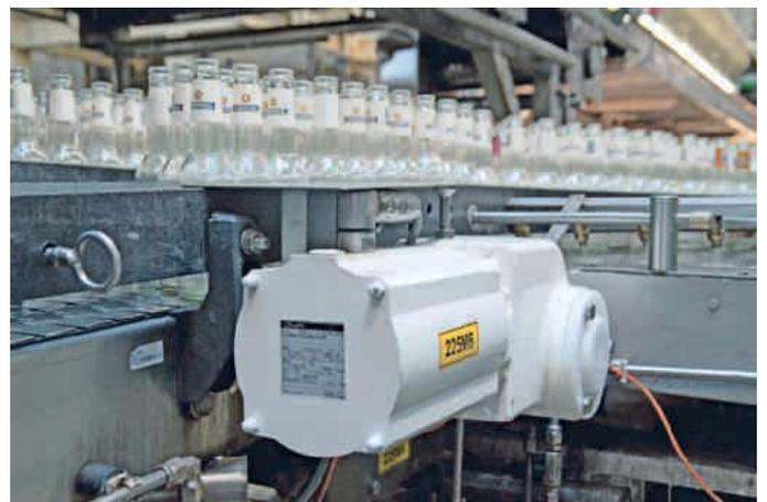
*Der VLT® OneGearDrive ist optimal für den Einsatz in Getränkeanlagen. Er ist EHEDG-zertifiziert und besitzt eine glatte Oberfläche.*
