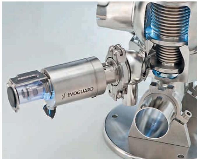
*Ein Aseptikdoppelventil von Evoguard. Die hermetische Abdichtung über Metallfaltenbalg stellt sicher, dass keine Produktkontamination von aussen erfolgen kann.*
