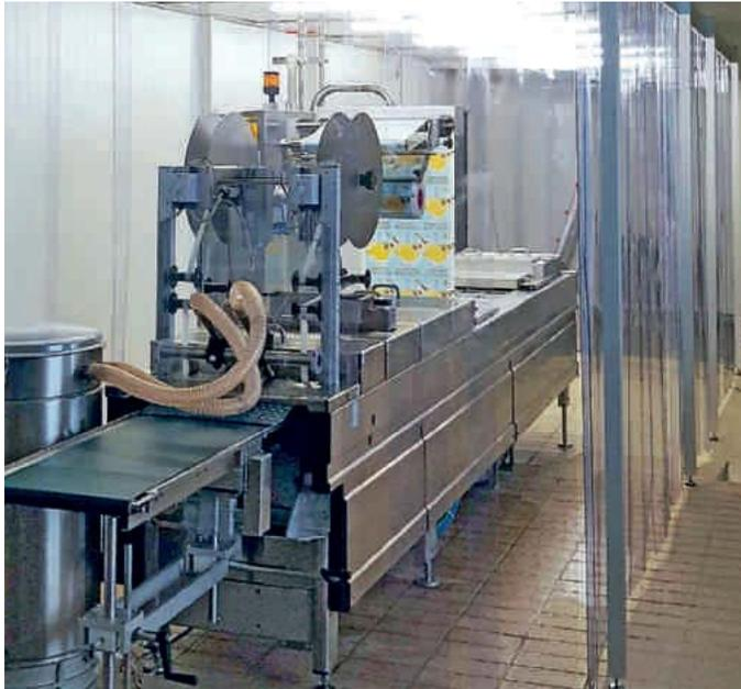
*Abfüllprozess Biojoghurt. Die Laminafloweinhausung CleanFlowCell® der Reinraumklasse ISO-7 ist fahrbar und kann flexibel und ortsunabhängig eingesetzt werden.*
