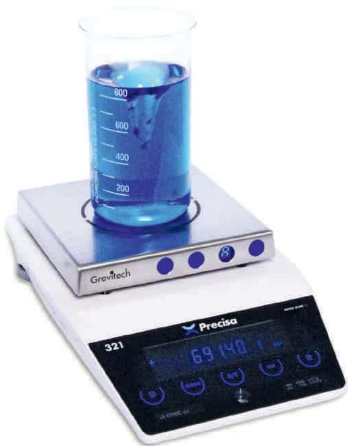
Der Magnetrührer kann manuell an der Waagschale oder über die Waagenschnittstelle vom PC aus gesteuert werden. Mit der Option der externen Steuerung ist es möglich, die Rührwaage in automatische Systemabläufe zu integrieren.
