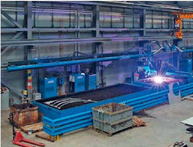
Im modernen Produktionsbetrieb in CH-4147 Aesch werden Ringe, Ronden, Form- und Zeichnungsteile nach den Vorgaben der Kunden auf Mass gefertigt. Für die Teile mit einer Dicke von 6 mm bis 150 mm kommen je nach den spezifizierten Anforderungen die CNC-Wasserstrahlschneid- oder -Plasmaschneidtechnik zur Anwendung. Sägezuschnitte und Laserteile werden von anderen Tochtergesellschaften der JACQUET Gruppe zugeliefert.
