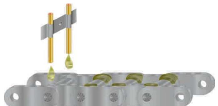
Illustration der Funktionsweise der TLB 2000: Das Öl wird punktgenau auf der Kette aufgebracht.
