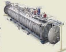
Band-Trockner für Vakuum- und Gefriertrocknung
