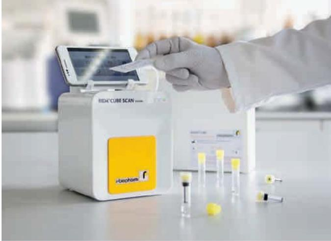
In den verschiedenen Testkits werden die Reagenzien als Einzeltests gebrauchsfertig mitgeliefert. Jede Testpackung enthält einen RFID Chip, der Testprotokoll und chargenspezifische Daten wie z. B. Verfallsdatum dem Automaten direkt kommuniziert. Eine manuelle Eingabe zum Test durch den Anwender ist damit unnötig und verhindert Eingabefehler.
