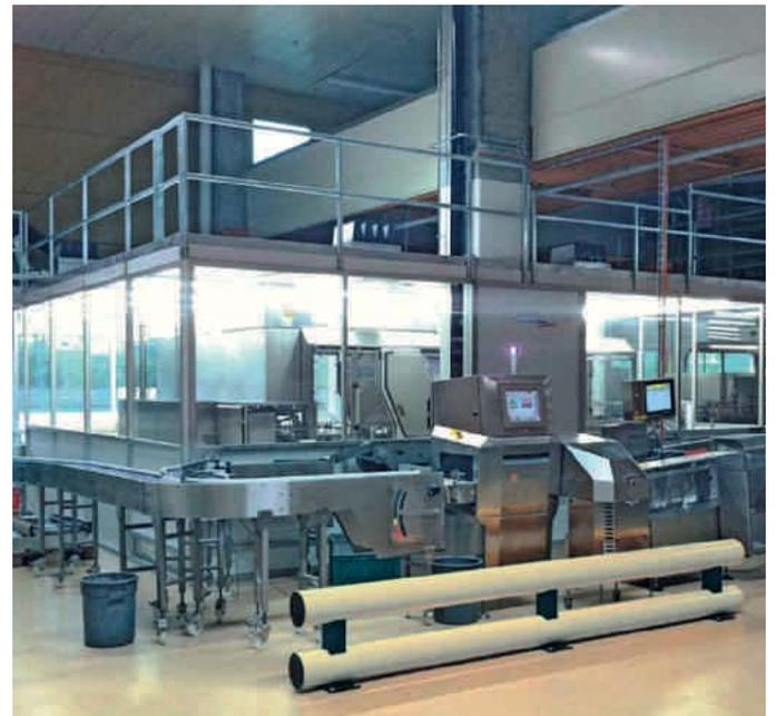
*Verpackung von Schnittbrot in einer Grossbäckerei. Das geschlossene System CleanSteriCell® der Reinraumklasse ISO-7 entspricht den Vorgaben der pharmazeutischen Produktion.*
