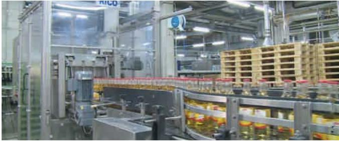
Seit Anfang 2015 ist im Glasauspacker eine absolute Neuheit von SEW-EURODRIVE, eine Configurable Control Unit mit dem Applikationsmodul Handling Kinematics, verbaut. Der Glasauspacker setzt gebrauchte Flaschen aus Kästen auf ein Fließband, das sie zur Waschanlage transportiert. Die Anlage, die von der Firma Rico in Ellwangen hergestellt wird, holt pro Auspackhub 48 Glasflaschen aus zwei Kästen. So werden bis zu 280 Flaschen pro Minute ausgepackt.
