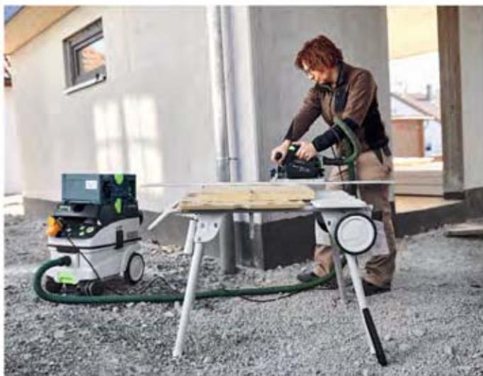
Noch komfortabler wird das Arbeiten mit dem speziell für die CSC SYS 50 entwickelten Untergestell UG-CSC-SYS.
