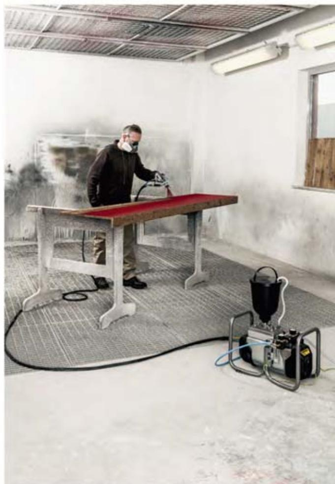
Einzigartig in der Branche: Die Abluft des IceBreaker-Motors klimatisiert Öl und Farbstufe, sorgt so für konstante Viskosität des Hydrauliköls und für eine konstante Leistungskurve. Die gleichmässige Motortemperatur bietet zudem einen erheblichen Vorteil bei der Verarbeitung temperaturempfindlicher Lacke.
