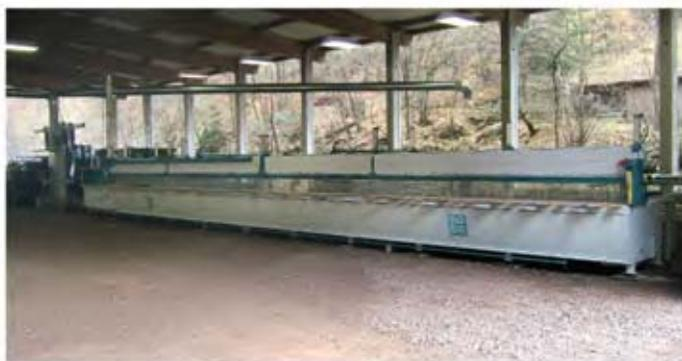
Alle MABA Längsschnitt-Kreissägen weisen eine Schnittbreite von 450 mm auf. Je nach Betriebsart sind auch Schnittbreiten bis zu 2500 mm einsetzbar. Alle MABA Längsschnitt-Kreissägen sind mit einer Schnitthöhe von 205 mm ausgerüstet. Optional kann die Schnitthöhe bis 300 mm erweitert werden.
