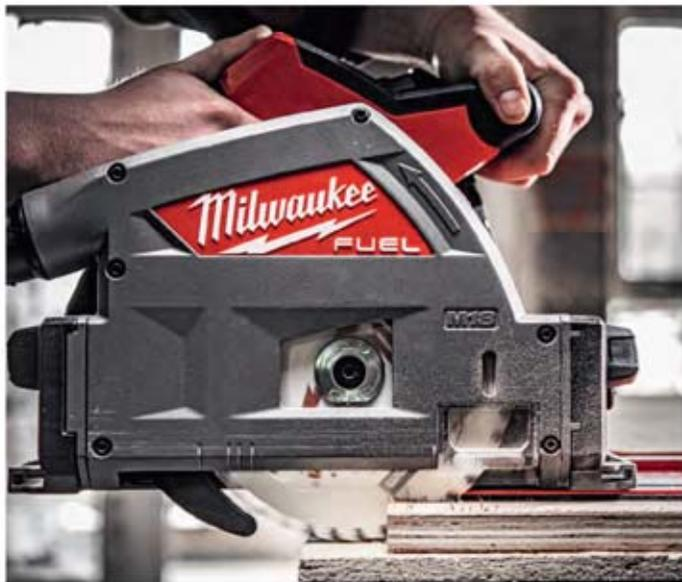
Die Neigungseinstellung hat Anschläge bei 22,5°, 45° und 48°. Ausserdem gibt es eine -1-Einstellung für einen Rückschnitt. In Verbindung mit einem externen Absaugsystem (DEK26-kompatibel) ist eine sehr effiziente Staubabsaugung möglich.
