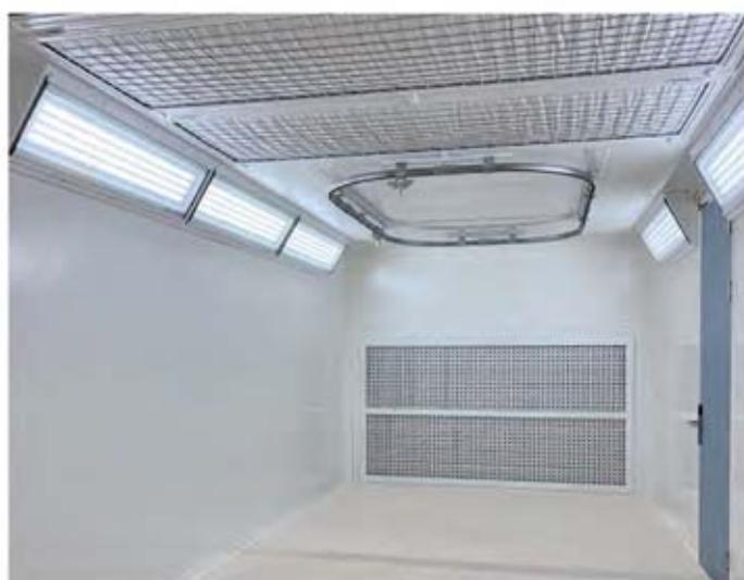
*Kombinierte Farbspritz- und Trocknungskabine mit LED-Beleuchtung.*
