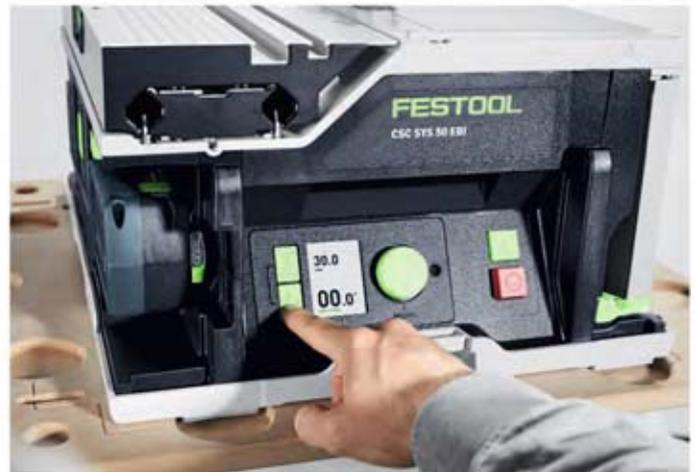
Über ein zentral positioniertes und gut ablesbares Display werden die Höhe und der Winkel absolut präzise und in kürzester Zeit eingestellt.
