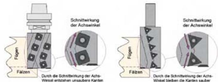
Die Anordnung der Achswinkel ist beim System mit den 4-Ecks-Wendeplatten nur wie abgebildet möglich, damit die Schnittkante des Messers mit dem Vorschneider übereinstimmt. «Die Achswinkel ziehen in die falsche Richtung.»
