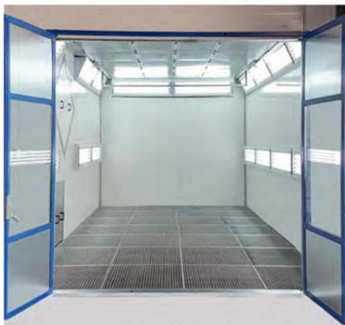
Mit einer grossflächig dimensionierten Absaugwand mit Filtersystem wird der Spritznebel (overspray) direkt erfasst, abgesaugt und filtriert. Die Filtereinrichtung sollte für alle anfallenden Farb- und Lackarten, aber auch Wasserlacke ausgelegt sein. Gleichzeitig wünscht der Kunde eine lange Betriebsstandzeit und kostengünstige Ersatzfilter.
