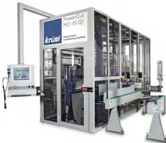
Die Fräs-, Säge- und Bohraggregate sind mit 1, 2 oder 4 Spindelköpfen ausgestattet und mit den gewünschten Werkzeugen bestückbar. Durch eine fixe Platzierung entfällt ein Werkzeugwechsel während dem Prozess, wodurch sich die Bearbeitungszeiten massiv verkürzen.
